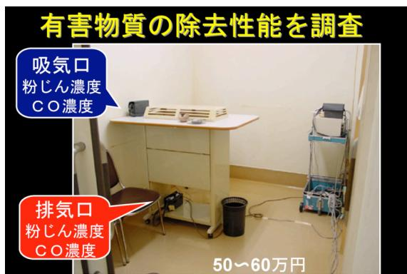
空気清浄機の給気口と排気口で粉じん濃度と一酸化炭素濃度を測定しました。
