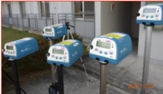
従来：重量濃度による微小粒子状物質(PM2.5)の測定による漏れの評価
